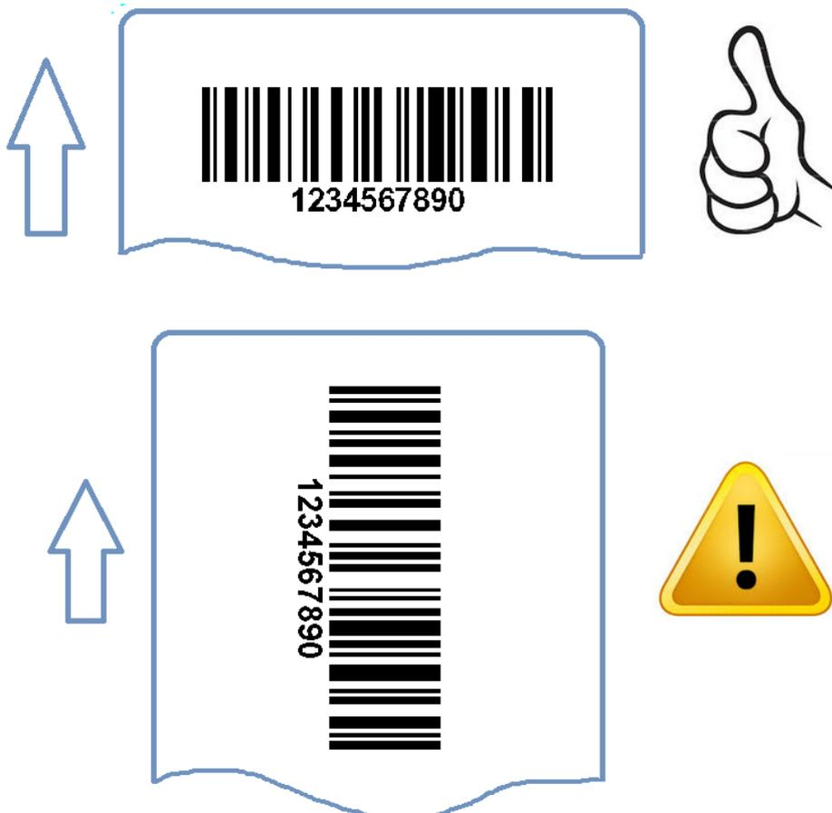
En caso de impresión de códigos de barras con las barras no paralelas a la dirección de impresión, incremente el valor de aumento por lo menos en 1 punto y reduzca la velocidad de impresión.
